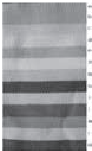
شکل ۳. پارچه چند جزئی تشکیل یافته از (a) استات، (b) اکریلیک ۱، (c) تری استات، (d) پنبه، (e) اکریلیک ۲، (f) پلی استر ۱، (g) پلی استر ۲، (h) پلی آمید (نایلون)، (i) اکریلیک ۳، (j) ابریشم، (k) مداکریلیک، (l) ویسکوز و (m) پشم رنگرزی شده با رنگزای ۲ در \text{pH} برابر ۷، ۹۸ درجه سانتیگراد و با استفاده از شید ۵٪.
